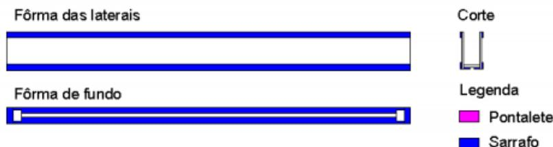
Figura 2: Fabricação de fôrma de viga interna (compensado)
